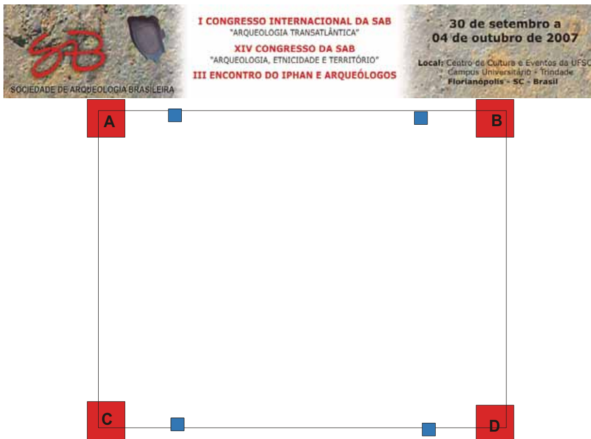
Figura 3 - Esquema da área ocupada pelas torres autoportantes, indicando a posição, no plano, dos 4 pés e das sondagens arqueológicas (em azul) – sem escala
